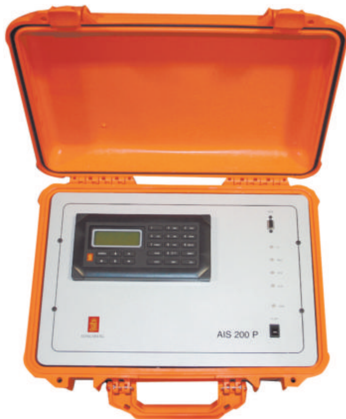
Ortung aus dem Koffer: Die mobilen Empfänger sind für Schiffe gedacht, die nur ab und an die Donau passieren. Foto: Via Donau
