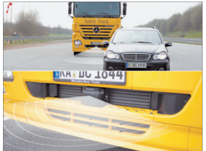
Die Abstandsregelung erkennt ein langsamer fahrendes Fahrzeug im Voraus und bremst den LKW. Foto: DaimlerChrysler
