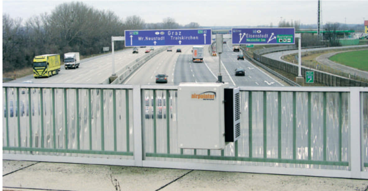
Messen, wo die Schadstoffe anfallen: Die neuen Messstationen passen sogar auf Autobahnbrücken und benötigen deutlich weniger Energie. Foto: recordum
