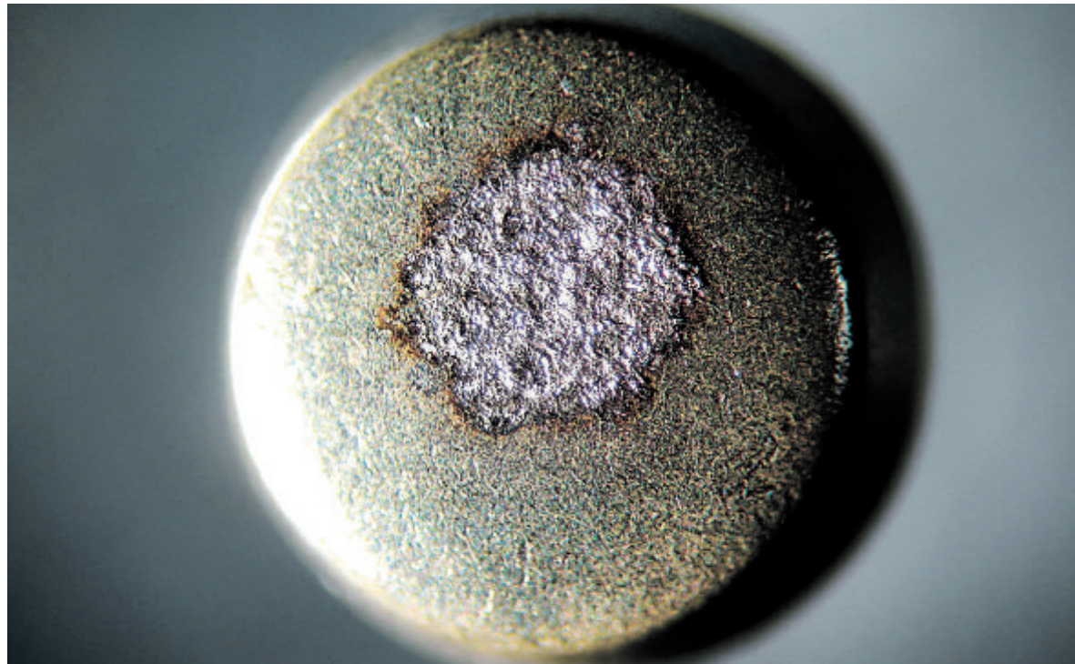
Kontaktwerkstoffe sind in der Regel extrem hohen Beanspruchungen ausgesetzt. Das wirkt sich auf ihre Lebensdauer aus. Eine neue Technik zeigt nunmehr Fehler an Schaltstellen auf. Foto: AC2T
